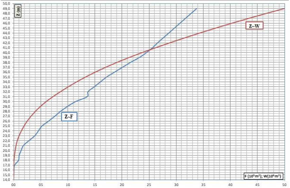
Hình PLII.3.1: Đồ thị quan hệ lòng hồ Đá Hàn Z(m) \sim F(10^5 m^2) \sim W(10^6 m^3)
